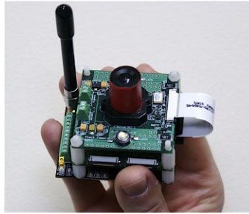
Slika 2 Izvedba CMOS kamere sa TI DSP procesorom i Fleck-3 pločicom (Wark, 2008.)
